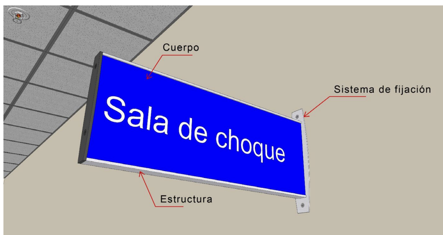
Figura 25. Partes de la señal en banderola
