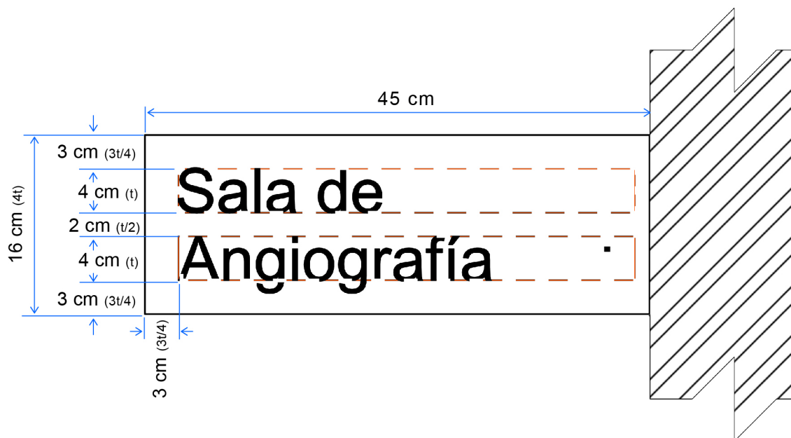
Figura 28. Dimensiones señal de banderola doble renglón
