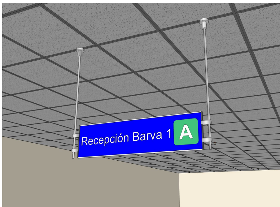
Figura 13. Ejemplo de señal cielítica identificadora
