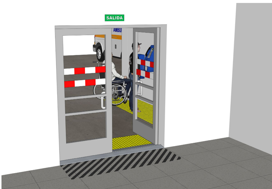
Figura 34. Correcta instalación de señal de salida
