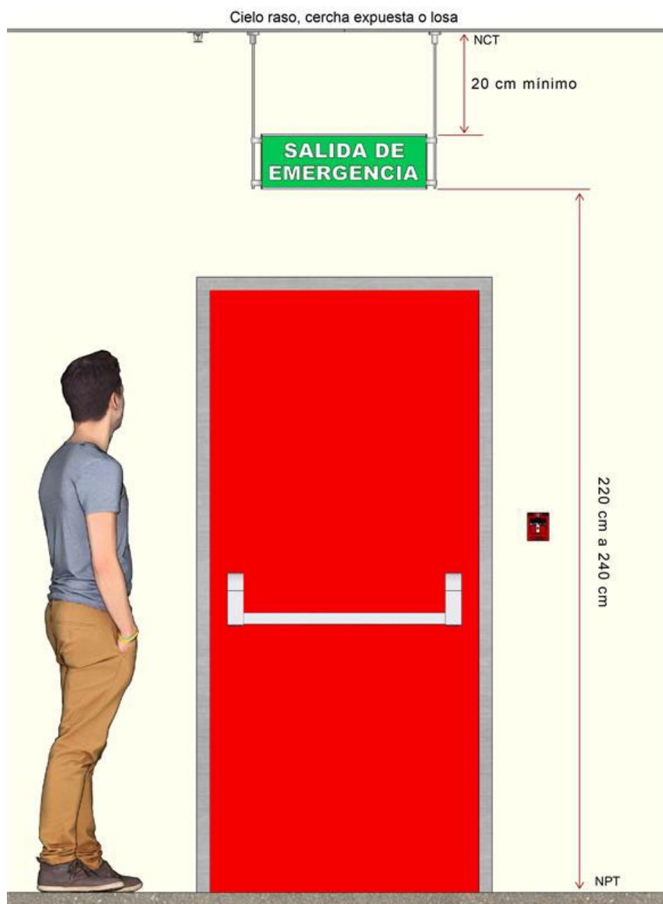
Figura 36. Altura de señalización cielítica en los medios de egreso
