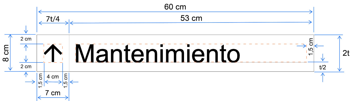
Figura 15. Dimensiones para señalización cieĺtica
