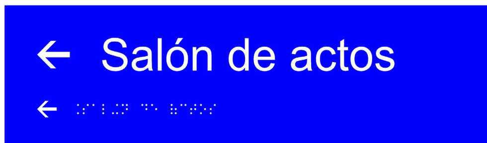
Figura 81. Orden y combinación de elementos en las señales
