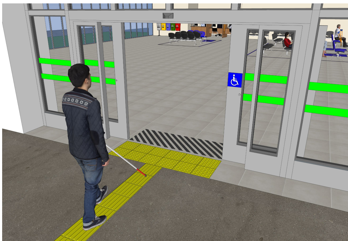
Figura 100. Señalización horizontal de información, prevención, advertencia o peligro
