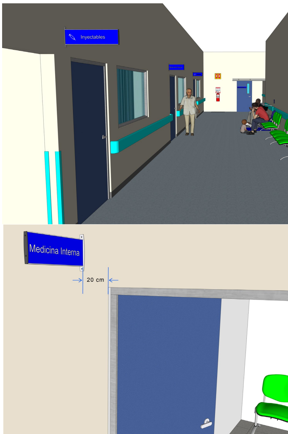
Figura 30. Ejemplo de colocación de banderola
