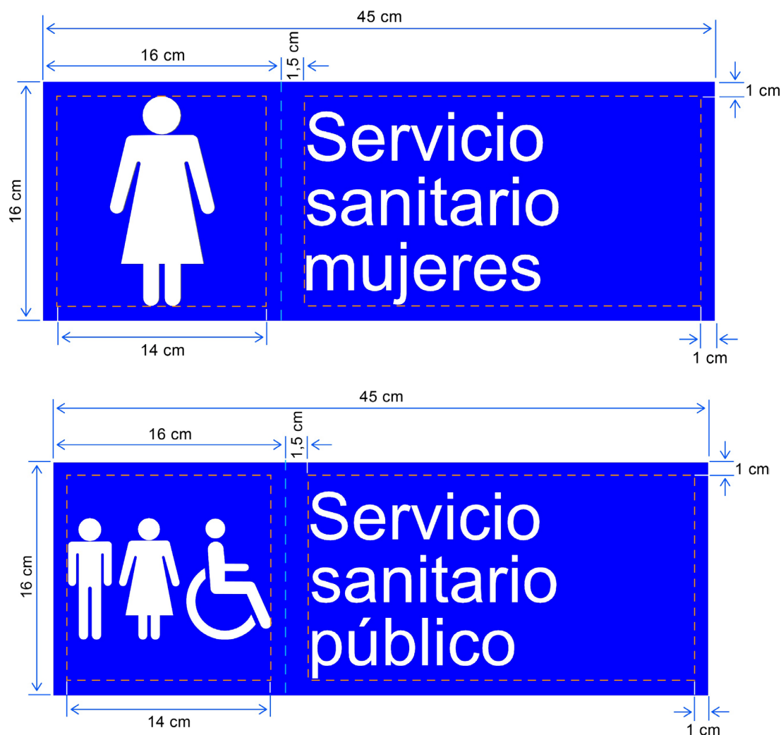
Figura 32. Ejemplos de señalización de casos especiales
