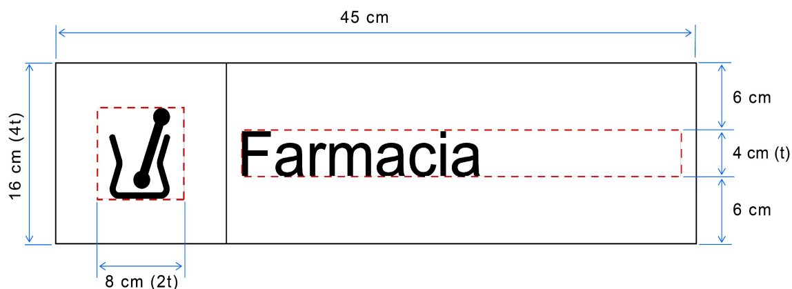
Figura 27. Dimensiones señal de banderola con pictograma
