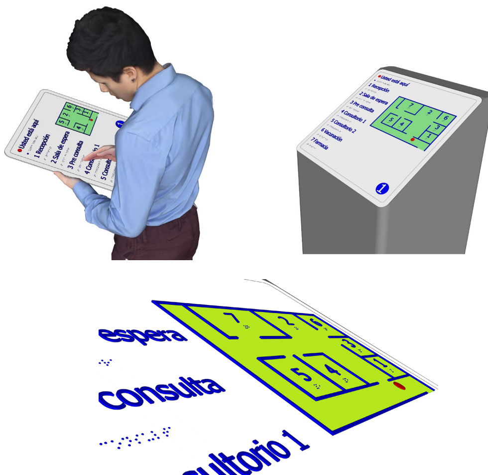
Figura 86. Ejemplo de diagrama háptico
