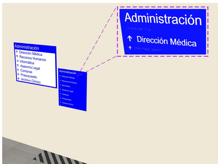
Figura 56. Directorio interno con señalización táctil
