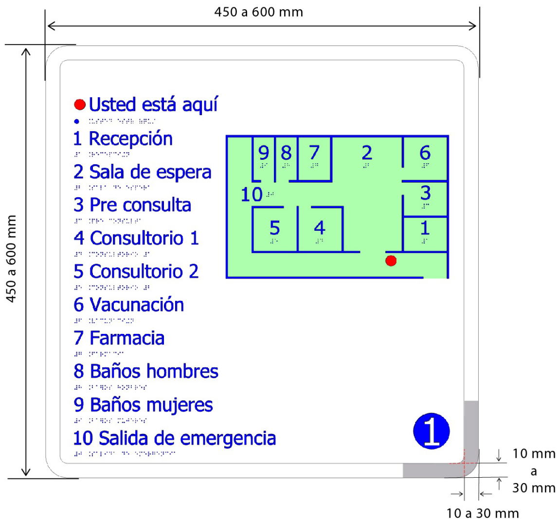
Figura 89. Dimensión y distribución de un diagrama háptico
