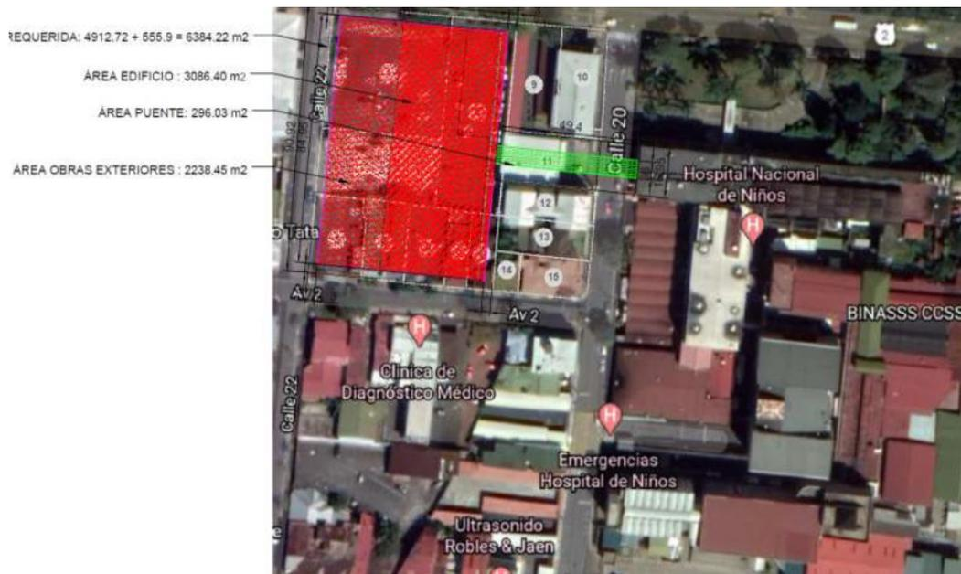
*“...Del esquema anterior la parte indicada de color rojo intenso corresponde a la huella del edificio, correspondiente a un área de 3 086,4 m<sup>2</sup> (36.33m de ancho por 84.95m de largo).*
